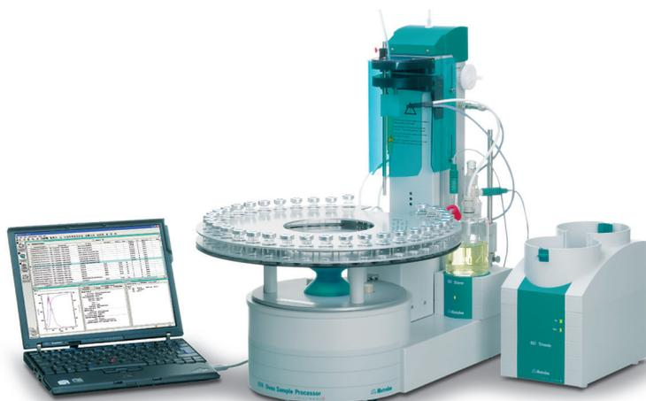
El 874 Oven Sample Processor, completamente automatizado, es el instrumento ideal para un número elevado de muestras. En la imagen con 851 Titrande.
