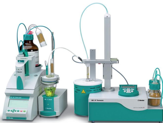
La técnica del horno Karl Fischer para la preparación fácil de muestras difíciles. La imagen presenta el 860 KF Thermoprep para la adición manual de la muestra.
