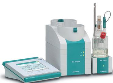
851/852 Titrandos – para determinaciones del contenido de agua en la gama de trazas. La imagen muestra el 851 Titrande.
