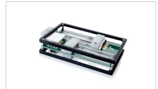
Celldiscoverer 7 ofrece una manera efectiva de mantener limpia la cámara de la muestra. El sistema reconoce automáticamente la placa de inserción para la desinfección por UV y se inicia el flujo de trabajo de desinfección mediante la pantalla táctil.
