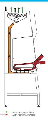
**Telstar BiOptima ONE** es una gama de cabinas de seguridad biológica clase I de gran calidad que garantizan el más alto nivel de protección para el operario y para el entorno.
