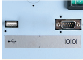
Puertos de comunicación RS 232 y host USB
